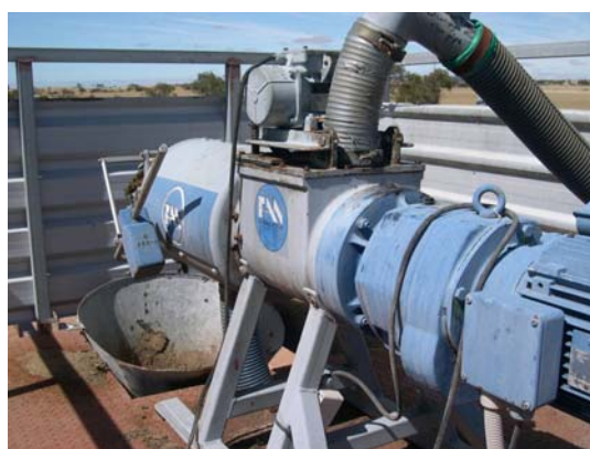
A FAN Screw Press separator
