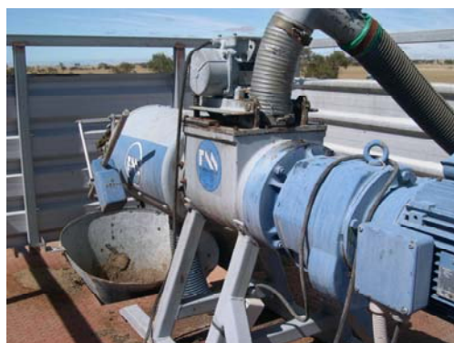
A FAN Press Screw Separator
